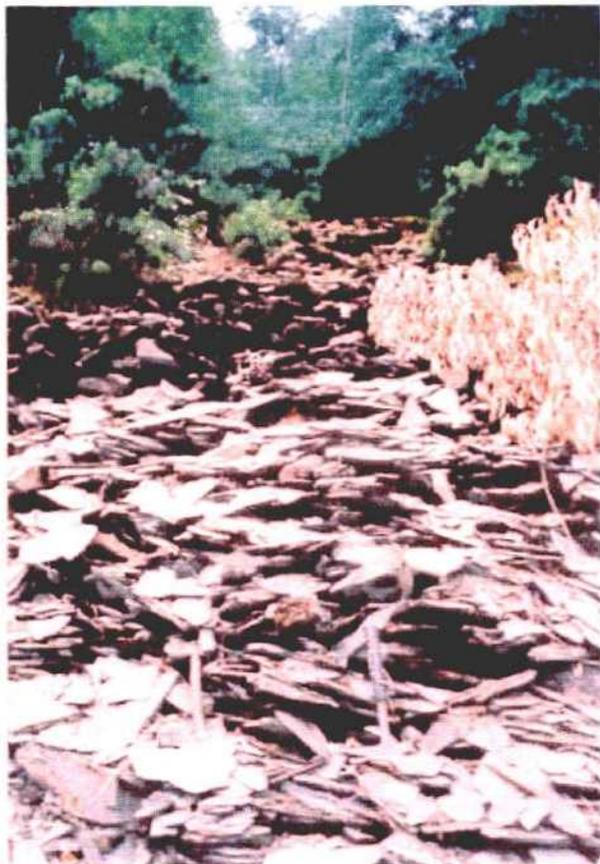
con una buena exfoliación las hace idóneas para su empleo en techumbres. El frente de explotación está muy devastado, lajeado y suelto, dando un aspecto de "canchal" constituido por lajas de pizarra (Fig.24), resultando imposible tomar medidas geomecánicas del afloramiento.
