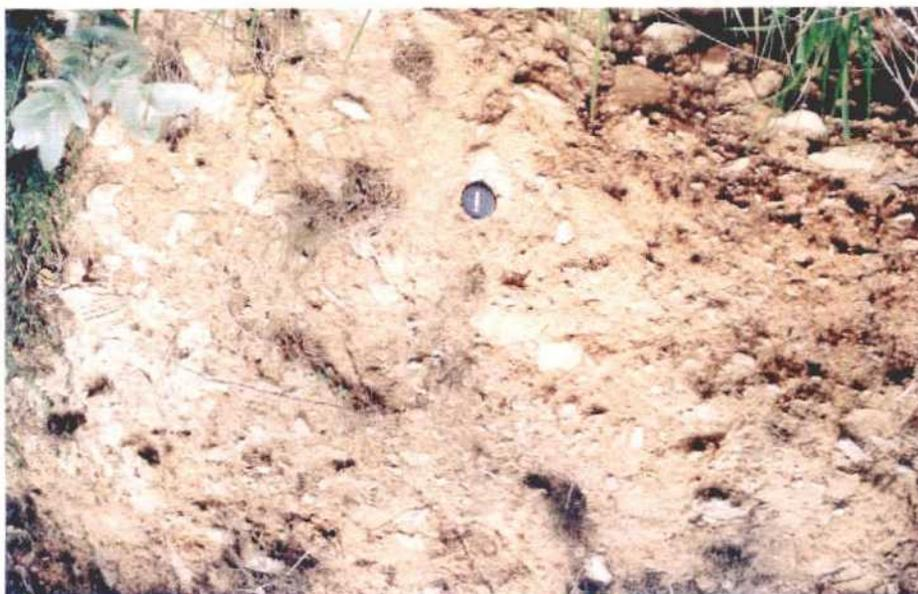
**FIG.23 SUELOS TIPO COLUVIÓN**
